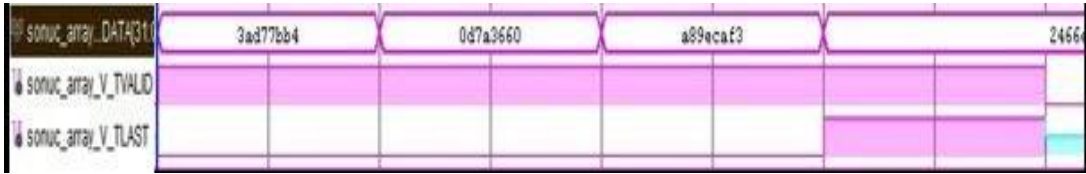
Şekil 5.31 : AXI4_Stream arayüzlü AES-128 şifreleme algoritmasının veri çıkarma testi.
