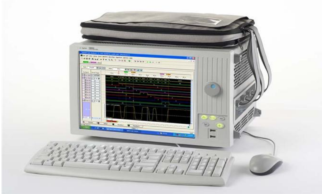
Şekil 2.17: Agilent 16802A Lojik Analizör [16]
