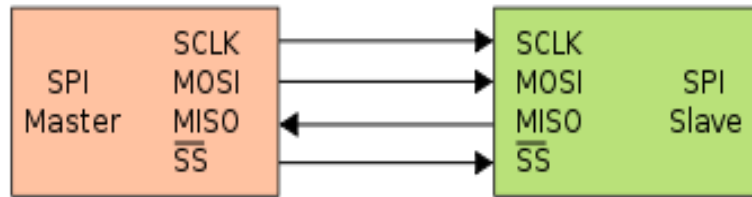
Şekil 2.1: SPI Birincil ve İkincil Cihazları ve Bağlantı Pinleri [7]
