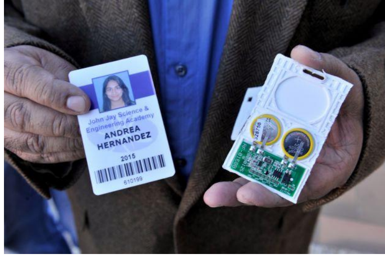
Şekil 3.10 : Öğrenci Kartlarına Uygulanan RFID Etiket.
