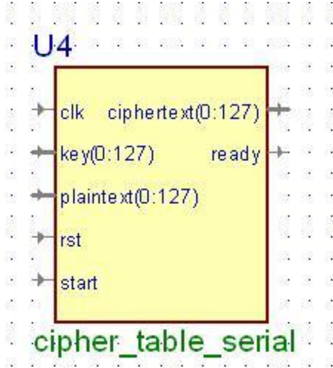
Şekil 5.5 AES modülünün Acvite-HDL’de blok gösterilimi
