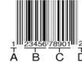
Şekil 2.1. Standard UPC. Kod parçaları şu şekilde etiketlenmiştir: (A) Uygulama kodu (B) Üretici kodu (C) Ürün kodu (D) Sağlama toplamı tamsayısı [3]
