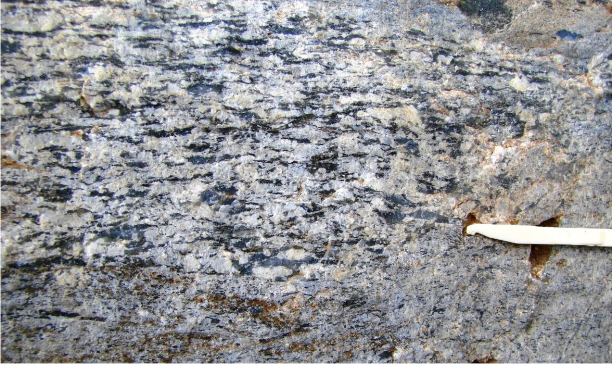
Şekil 7 - Kapanca metagranitoidi. Koyu renkli kesimler kuvarstan, beyaz kesimler ise jadeitten oluşmaktadır.
