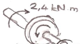
$$T_{BC} = 2,4 - 1,2 \\ = 1,2 \text{ kN.m}$$
