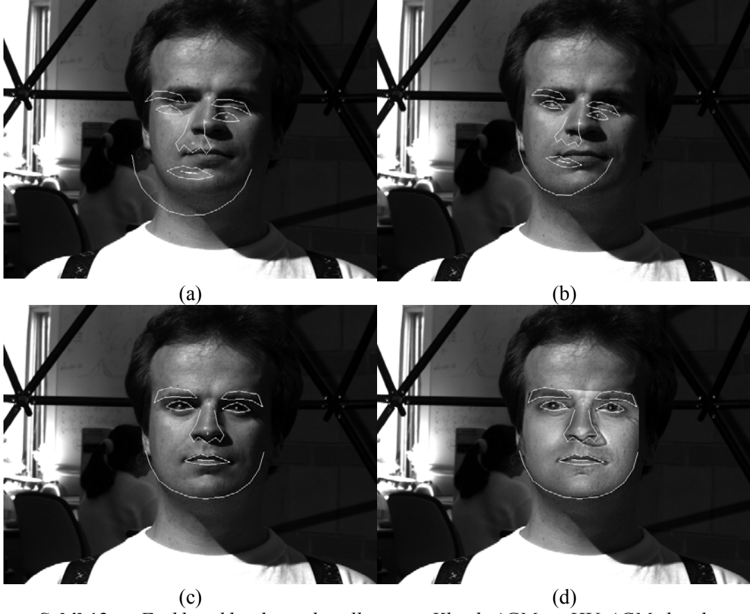
Şekil.13 Farklı ışıklandırma koşulları için Klasik AGM ve HU-AGM hizalama sonuçları. a) İlkendirme, b) Klasik AGM hizalama sonucu, (c) HU-AGM hizalama sonucu, d) HU-AGM + RI restorasyon ve hizalama sonucu.
