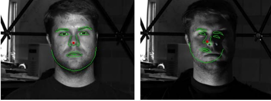
Şekil.1 Klasik AGM kullanılarak yüz hizalama: a) Normal ışıklandırma altında çekilmiş yüz için hizalama sonucu, b) Kötü ışıklandırma altında çekilmiş yüz için hizalama sonucu.
