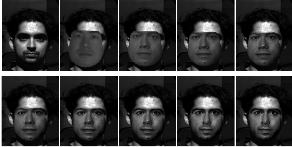
Şekil 21. Bir adet tam karşıdan aydınlatılmış görüntüsü kullanılarak eğitilen Birleşik Model'in aynı kişiye ait farklı aydınlatılmış test (unseen) görüntüsü için çevrimlere göre (soldan sağa, yukardan aşağıya) yakınsama sonuçları. İlk
