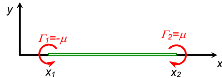
Şekil 10.8: Duble dağılımına özdeş girdap sistemi
