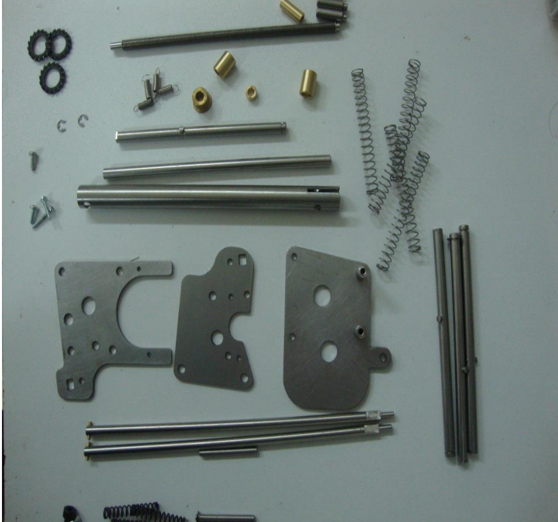
Şekil 4.23: 304 Kalite paslanmaz çelikten üretilen cihaz parçaları.
