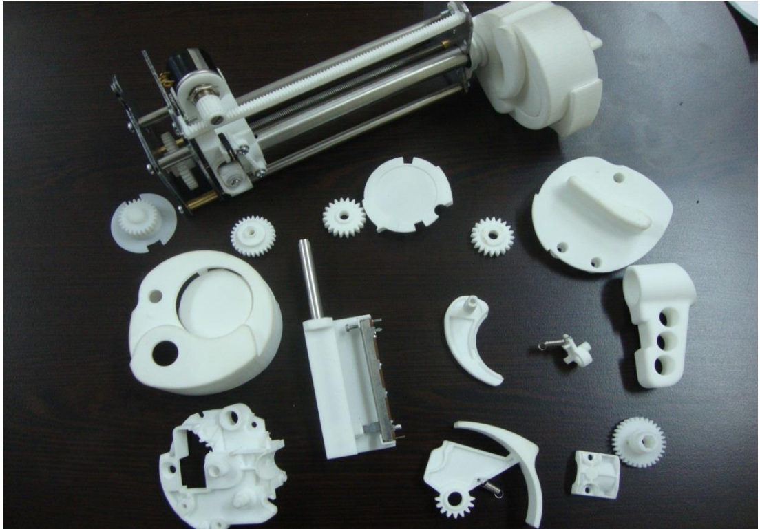
Şekil 4.21: Poliyamid malzemeden üretilmiş plastik parçalar.
