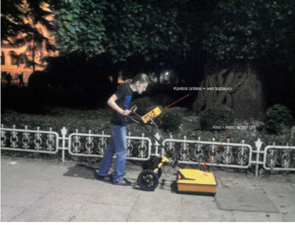
Şekil 2: Sultan Ahmet Camii arazi ölçümlerinde kullanılan USRADAR marka 250 Mhz merkez frekanslı antene sahip bir jeoradar düzeneği.
