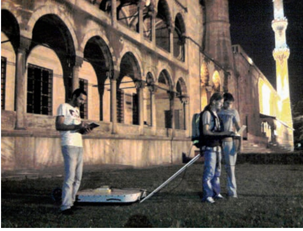
Şekil 3: Derin jeolojik birimleri, yeraltı suyunu ve olası kırık-çatlak-fay zonlarının araştırılmasına yönelik kullanılan MALA marka 100 Mhz merkez frekanslı antene sahip bir jeoradar düzeneği.
