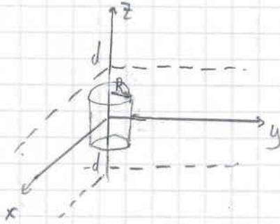
Gauss yüzeyi R yarıçaplı silindirik yüzeyi
