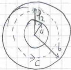
$$I_{ic} = I_1 + \int \vec{J} \cdot d\vec{s} \quad d\vec{s} = \rho d\rho d\phi \vec{e}_z$$
