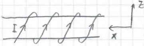
Sağ el kuralına göre solenoidin içinde  $\vec{B} = B\vec{e}_x$  Toroidal bobine benzer şekilde dışarıda  $\vec{B} = 0$
