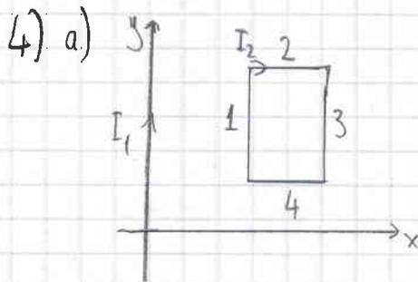
1. kenara etkiyen kuvvet için  $d\vec{F}_1 = I_2 d\vec{l} \times \vec{B}_1$
