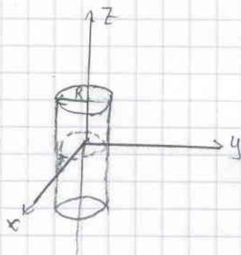
Elektrik alanının yapısı gereği sadece silindirin iki tabanından geçer. Yan yüzey için  $d\vec{s} = pd\phi dz \vec{e}_\phi$
