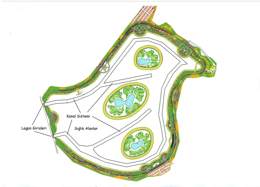
Şekil 5. Tuzla Belediyesi Fen İşleri Müdürlüğü'nden alınan son durum lagün konfigürasyonu. Lagün içi kanallar, Marmara Denizi'ne açılan lagün girişleri ve oluşturulacak üç adanın konumları açık olarak gösterilmektedir.
